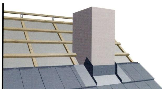
Butylové lepidlo umiestnené po celom povrchu zaistuje tesné spojenie so škridlou.
